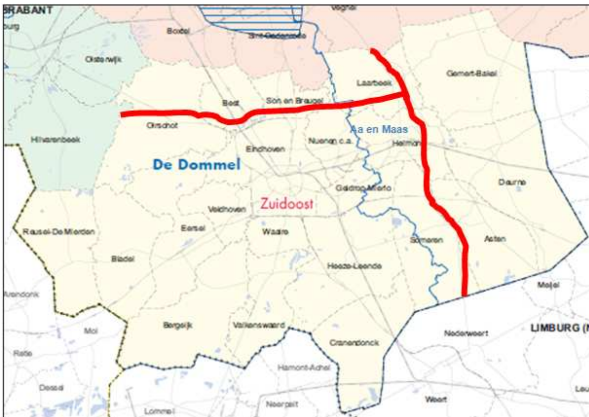
Figuur 1: beheersgebieden waterschappen Aa en Maas (rechts van blauwe lijn) en De Dommel (links van blauwe lijn) in VRBZO (gele vlak). Wilhelminakanaal en Zuid-Willemsvaart in beheer bij Rijkswaterstaat (rode lijn).
